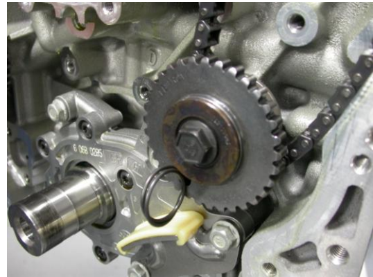
Left side idler w/grenade pin.
