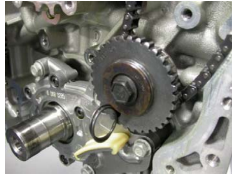
Left side idler w/grenade pin.
