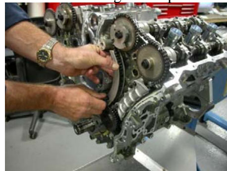
Left side idler w/grenade pin.
